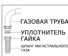
Для подключения к магистральному газу установите прокладку в гайку на конце шланга. Закрутите гайку шланга на резьбу магистральной трубы прибора, проверьте соединение на предмет утечки газа.
