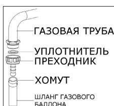
Для подключения к газовому баллону установите хомут на шланг газового баллона. Установите переходник в гибкий шланг газового баллона, предварительно нагрев конец шланга в кипящей воде. Зафиксируйте хомут на конце шланга и закрутите фиксирующий винт хомута при помощи инструмента. Установите прокладку в переходник (как показано на рисунке) и закрутите гайку переходника на резьбу магистральной трубы прибора.
