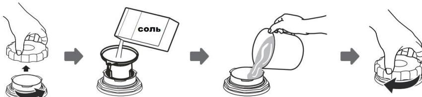
1. Снимите нижнюю корзину и открутите крышку резервуара.
