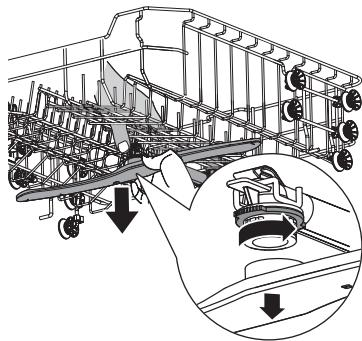
**1** Чтобы снять верхний разбрзгиватель, заjmите гайку и поверните разбрзгиватель против часовой стрелки.
