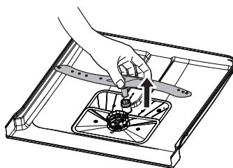
**2** Потяните нижний разбрзгиватель вверх, чтобы снять его.
