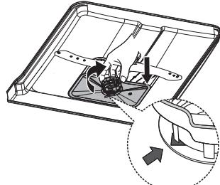
**4** Соберите фильтры в обратной последовательности, вставьте фильтр в сборе в нижнюю часть посудомоечной машины и поверните по часовой стрелке, заблокировав фильтры.
