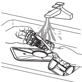
**3** Крупные остатки пищи можно удалить промыв фильтр под проточной водой. Для более тщательной очистки используйте щетку.
