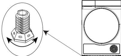
После того как прибор будет установлен в место предполагаемого использования, отрегулируйте его по уровню с помощью инструмента, затем зафиксируйте положение. Сушильную машину следует устанавливать на твердой и ровной поверхности.
