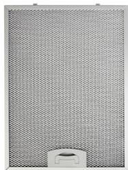
Жировой фильтр задерживает частицы масла попадающие в воздух, и в зависимости от частоты использования вытяжкой могут стать причиной закупорки фильтра. Для обеспечения противопожарной безопасности жировой фильтр рекомендуется очищать не реже одного раза в 2 месяца.
