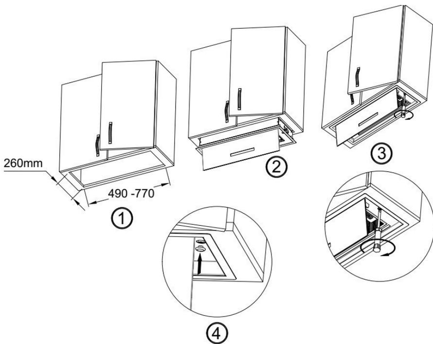
Установка вытяжки в мебельный шкаф.
