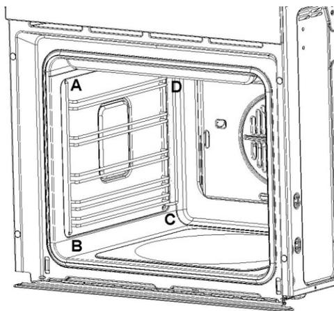
Для того, чтобы снять боковые решетки (как правую, так и левую), совершите следующие действия: бережно потяните и достаньте их из отверстий (A) и (B); повторите то же действие для снятия из отверстий (C) и (D).
