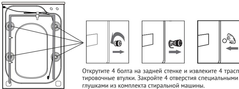
Открутите 4 болта на задней стенке и извлеките 4 транспортировочные втулки. Закройте 4 отверстия специальными заглушками из комплекта стиральной машины.
