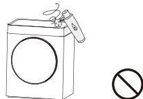
Когда сушильная машина запущена, не используйте горючие аэрозоли поблизости. В случае утечки бензина или утечки горючего газа, не подключайте и не вынимайте вилку из розетки и не включайте/выключайте сушильную машину.
