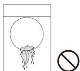
Не кладите мокрую одежду, не подвергавшуюся отжиму, непосредственно в сушильную машину для сушки. Пожалуйста, поместите одежду в сушилку после обезвоживания, чтобы избежать попадания капель воды на электрические компоненты и их повреждения.
