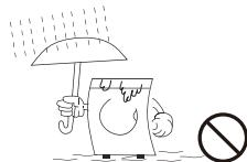
Сушильную машину нельзя устанавливать на открытом воздухе или во влажной среде. Если на нее попала вода, перед использованием машина должна быть просушена.
