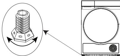
После того как прибор будет установлен в место предполагаемого использования, отрегулируйте его по уровню с помощью инструмента, затем зафиксируйте положение. Сушильную машину следует устанавливать на твердой и ровной поверхности. Разместите сушильную машину вблизи места ее использования удалив упаковочный материал.
