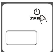
Чтобы батарейки питания прослужили вам дольше в приборе , предлагаем экономить энергию и выключать прибор сразу после окончания работы нажмите **POWER ZERO**.
