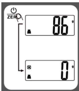
Для последовательного взвешивания различных грузов, не снимая их с весов, положите на весы первый груз,
